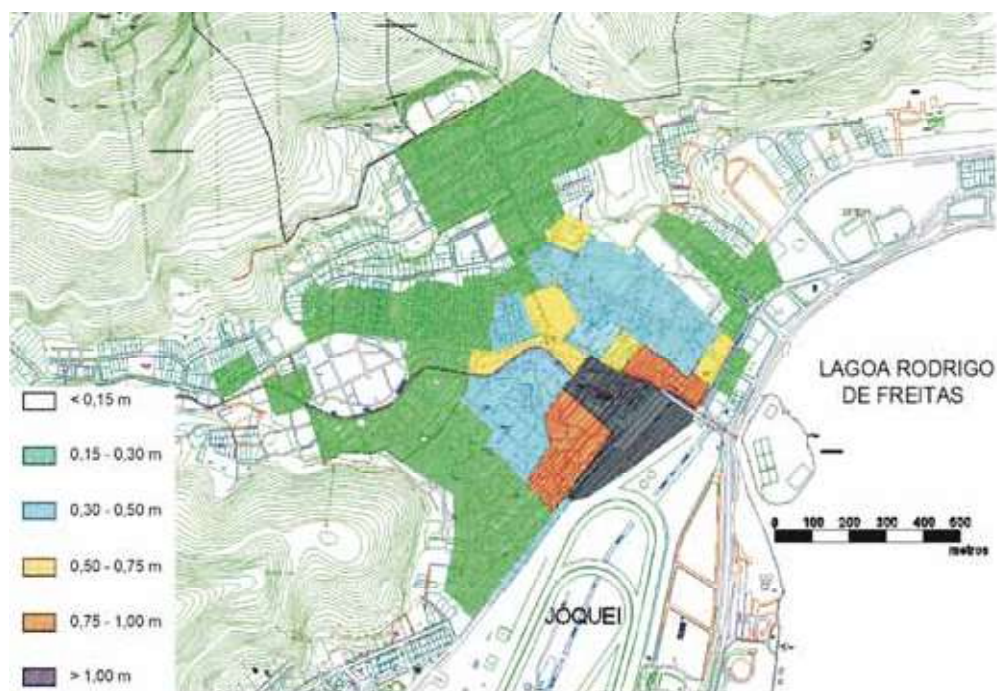
Figura 7- Simulação de áreas de inundação obtidas no MODCEL. Fonte: MIGUEZ et AL., 2012
